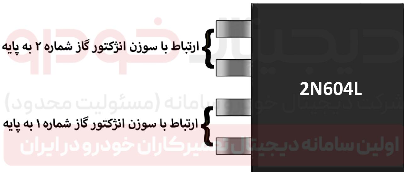
ارتباط با سوزن انژکتور گاز شماره ۲ به پایه ۵۹ کانکتور ECU
