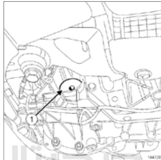
کاسه نمد خروجی دیفرانسیل سمت راست را با استفاده از ابزار (25412090) (۱) نصب کنید.
