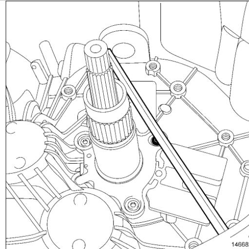
■ با استفاده از یک خط کش، بررسی کنید که سر پیچ‌ها از فرورفتگی لوله راهنمای کلاچ بیرون نزده باشد.
