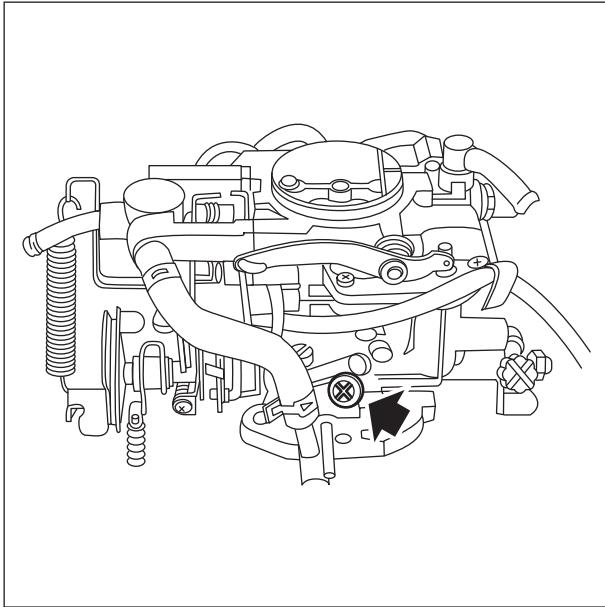
۵- با پیچاندن پیچ تنظیم سوخت در دور آرام مقادیر زیر را تنظیم کنید:
