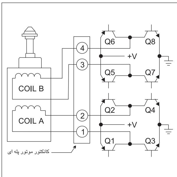
دیاگرام عملکرد موتور پله ای دو قطبی و جدول مدار منطقی آن
