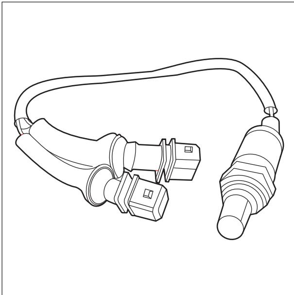
سنسور اکسیژن در صورتی به درستی عمل می کند که دمای سنسور حداقل ۲۰۰ درجه سانتی گراد باشد، بنابراین هنگامیکه موتور در حالت سرد استارت خودده و یا در هوای سرد در حالت دور آرام باشد، سنسور باید گرم شده تا به دمای عملکرد مطلوب برسد.
