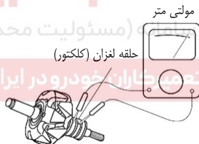
شکل ۳-۲۵: کنترل مدار بسته بین رینگ های روتور
