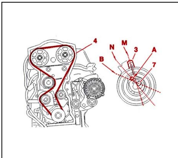
تسمه سفت کن (7) را شل کنید ، توسط آچار آلن در نقطه (A) ، تسمه سفت کن را در جهت عقربه های ساعت بگردانید تا شاخص (3) به موقعیت (B) برسد ، در این حالت تسمه کاملاً شل شده است . تسمه سفت کن را در موقعیت (B) ثابت کنید .
