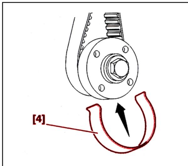
برای ثابت نگهداشتن تسمه تایم بر روی دنده سر میل
