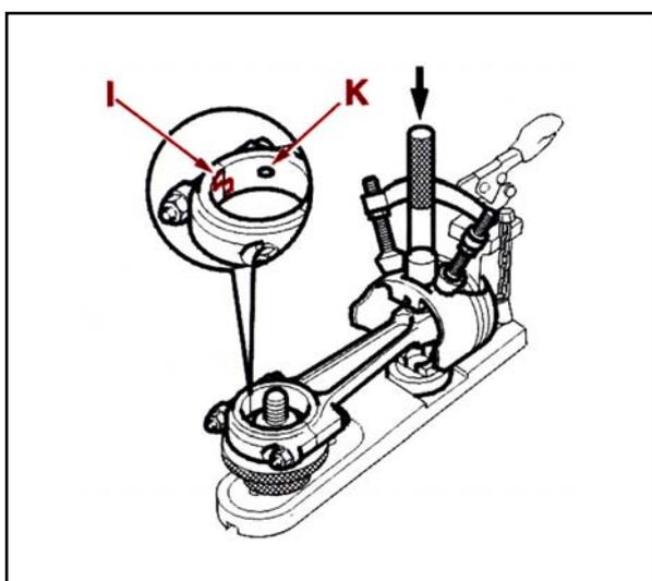
در شاتونهایی که سوراخ روغن برای روغنکاری زیر پیستون در آنها تعبیه شده است، (K) دقت کنید که این سوراخ باید سمت خار یاتاقانها، قرار گیرند.
