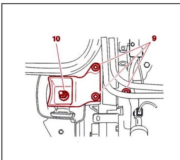
ابتدا ابزارهای [1] ، [2] ( کداختصاصی ۲۴۴۱۳۰۱۴ ) را به محل مخصوص بر روی موتور ، متصل کنید و توسط یک جرثقیل موتور را از بالا ، نگه دارید . سپس با باز نمودن پیچ های (9) و (10) دسته موتور سمت راست (سمت گیربکس) که به بدنه متصل می کنند ، را آزاد کنید .
