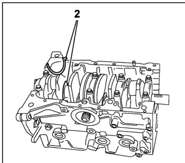
بغل یاتاقان (2) سمت بلوک سیلندر روی کپه شماره (2) روغنکاری کرده و سپس نصب نمایید .
