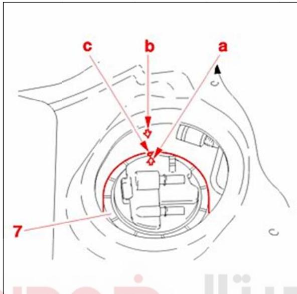
• در هنگام قرار دادن درجه داخل باک ( پمپ بنزین ) به داخل باک، جهت پیکان (a) را با نشانه (b) همراستا نمایید .
