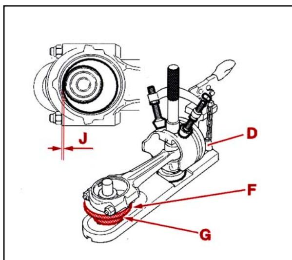
شاتون را بر روی مهره های (F, G) قرار دهید، شاتون را درون پیستون قرار دهید. مجموعه گژین پین و جازن را برای هم راستا نمودن شاتون در پیستون، مطابق شکل روبرو استفاده کنید. برای تنظیم ارتفاع شاتون و عمود نمودن آن نسبت به محور گژین پین، مهره های (F) را بچرخانید.
