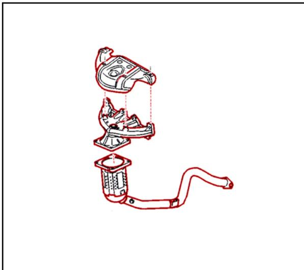
به منظور حفاظت از لوله های هیدرولیک فرمان ، بر روی منیفولد آگزوز ، محافظ حرارت گیر نصب شده است. کاتالیک کانورتور ، مستقیماً به زیر منیفولد آگزوز وصل شده است . برای حفاظت از فیلتر روغن نیز ، یک محافظ حرارت گیر دیگری نصب شده است.
