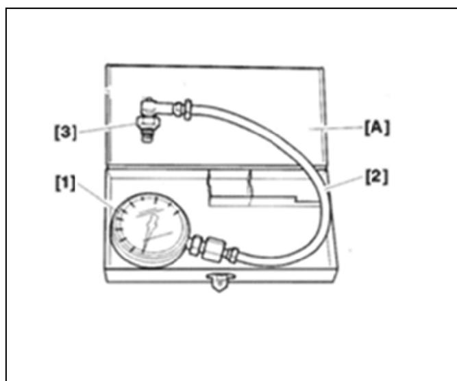
**اندازه گیری فشار روغن**
