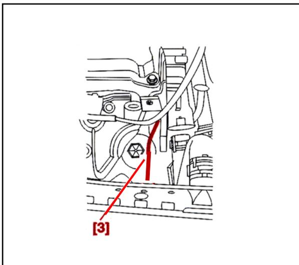
میل لنگ را با استفاده از ابزار مخصوص تایم میل لنگ [3] که در محل خود بر روی فلاپویل ، نصب می شوند، تنظیم کنید . سپس ابزار مخصوص [3] (جزء کیت ابزار با کد اختصاصی ۲۴۴۱۱۰۰۷) را خارج کنید و میل لنگ را  $\frac{1}{4}$  دور در جهت عکس گردش موتور بچرخانید.
