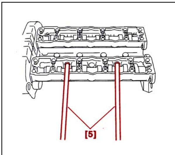
سرسیلندر را با استفاده از ابزار جابجا نمودن سرسیلندر [5] (کد اختصاصی ۲۴۴۰۸۰۰۸)، از محل خود جدا نمایید. دقت نمایید که در هنگام برداشتن سرسیلندر، به قاب تسمه تایم صدمه ای وارد نشود. واشر سرسیلندر را جدا نمایید و محل نشست واشر و سیلندر و سرسیلندر را تمیز نمایید.
