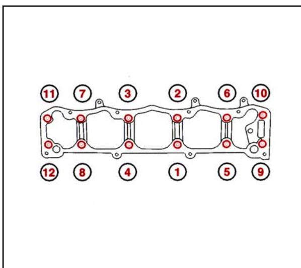
پیچ های سرسیلندر را به ترتیب نمایش داده شده در شکل از 1 تا 12 ببندید.
