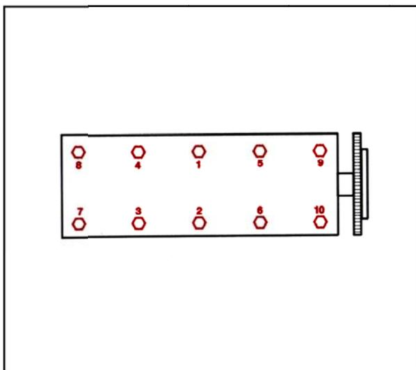
**نکته:** پیچهای سرسیلندر را مطابق شکل سفت نمایید.
