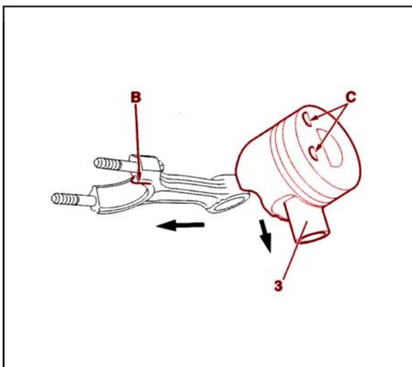
نکته : در زمان جا زدن گزن پین (3) در داخل پیستون در صورت تعویض نشدن قطعات ، آنها را جابجا نبندید .
