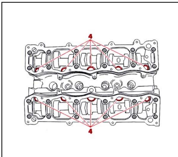
توجه: توسط آچار بکس ستاره ای پیچهای سرسیلندر (4) را به صورت مارپیچی و از بیرون به داخل به ترتیب باز نمایید، سپس پیچهای سرسیلندر (4) را بیرون آورید.
