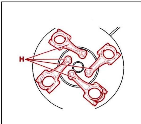
پس از تنظیم شاتون با محکم نمودن مهره قفل کن (G)، از حرکت مهره (F) جلوگیری کنید. به دلیل اینکه گژین پین درون شاتون جا زده می شود، لازم است که انتهای شاتون را مطابق شکل روبرو تا دمای حدوداً ۲۵۰ سانتیگراد، داغ نمایید. در صورت در دسترس نبودن دماسنج یک قطعه قلع کوچک در محل های نشان داده شده (H) قرار دهید. و به محض ذوب شدن قلع دما کافی است.
