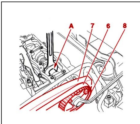
با ثابت نگه داشتن میل سوپاپ به کمک آچار تخت در نقطه A، پیچ نگهدارنده دنده میل سوپاپ را باز کنید.
