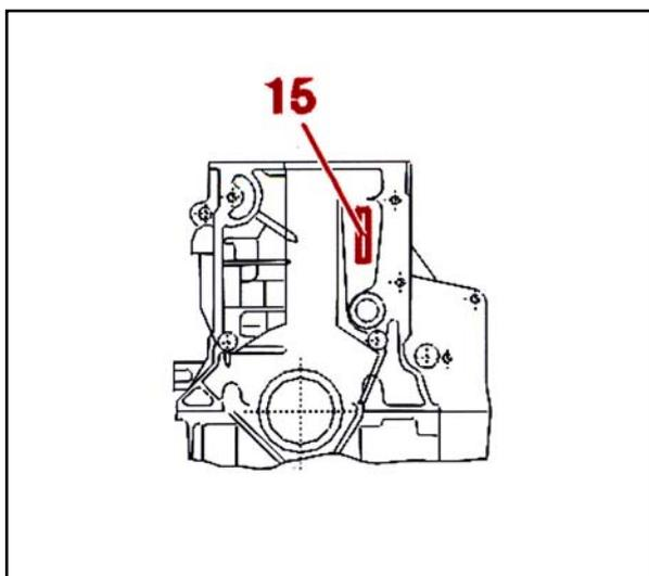
برای استفاده از روش جدولی ، می بایست از بارکد یا علائم حک شده بر روی بلوک سیلندر (15) نیز استفاده کنید .
