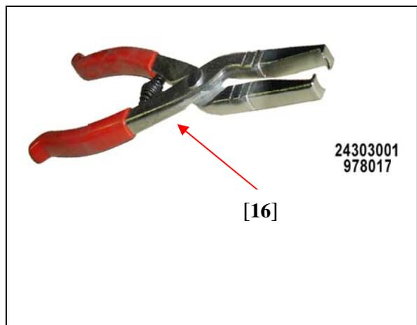
از ابزار مخصوص [16] ( کد اختصاصی ۲۴۳۰۳۰۰۱ ) برای بیرون آوردن کاسه نمد ساق سوپاپ استفاده نمایید.
