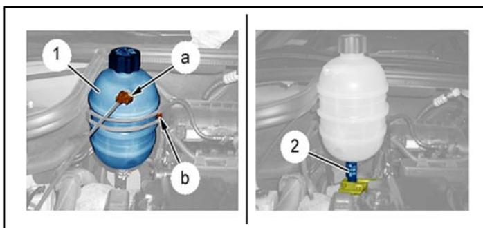
با استفاده از ابزار مخصوص ۲۶۶۰۱۰۰۱ شیلنگ خروجی
