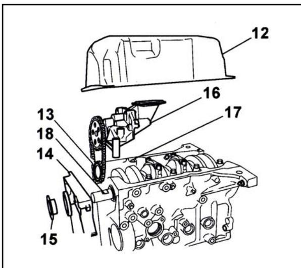
کارتز (12) و سینی نگهدارنده کاسه نمد سر میل لنگ (14) را باز نمایید.
