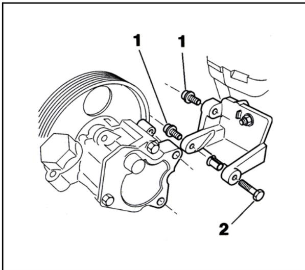
با باز نمودن پیچ های 1 و 2 پمپ هیدرولیک فرمان را بدون باز نمودن لوله های هیدرولیک از موتور جدا کنید . کمپرسور کولر را بدون جدا نمودن لوله های کولر ، از موتور جدا کنید . محافظ حرارت گیر دینام و پمپ هیدرولیک فرمان را باز کنید .
