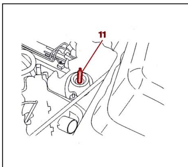
ابتدا پیچ دو سر رزوه متصل کننده گیربکس به دسته موتور سمت چپ را به چسب SPAGRAH آغشته کنید و بر روی گیربکس ، نصب کنید .
