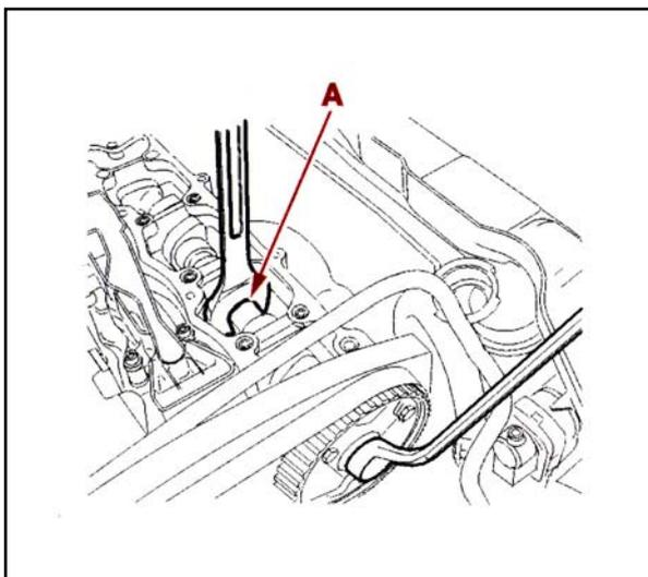
میل سوپاپ را با آچار تخت در نقطه A ثابت نگه داشته و پیچ آن را به اندازه (8) دکانیوتن متر سفت کنید. دقت کنید میل سوپاپ و دنده آن به راحتی در جای خود بچرخد.
