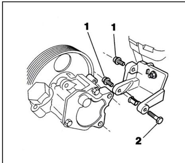
برای نصب پمپ هیدرولیک فرمان ، پیچ های (1) را به میزان ۲/۵ دکانیوتن متر و پیچ (2) را به میزان ۲/۲ دکانیوتن متر محکم کنید .
