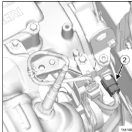
کانکتور شیربرقی سیستم تغییر فاز میل سوپاپ دود (۲) را جدا کنید.
