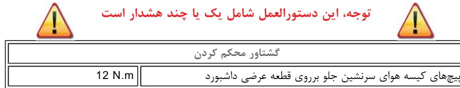
برای محل قرارگیری اجزاء و مشخصات (گشتاور محکم کردن، قطعاتی که حتماً باید تعویض شوند، غیره) (به 57A، تجهیزات داخلی، مجموعه داشبورد: نقشه جزئیات رجوع کنید).
