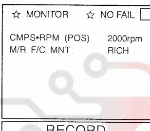
آزمایش عیب یابی در حالت (مد) II را انجام دهید (نظرارت بر حسگر حرارتی اکسیژن)
