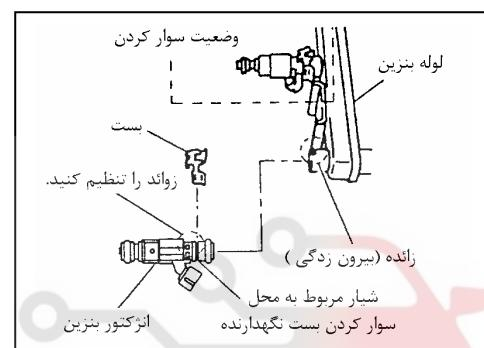
با دقت اورینگ‌ها (شامل اورینگ رگلاتور فشار) را سوار کنید. **مسئولیت محدود**
