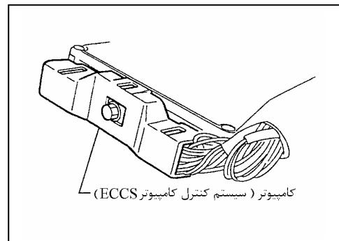
۳. اندازه‌گیری تمام ولتاژها را در حالت وصل بودن سوکت انجام دهید. نوک قلم ولتمتر را مانند شکل بلندتر کنید تا بتوانید به آسانی آزمایش را انجام دهید.
