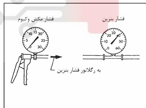
۳. گیج فشار سنج را بین فیلتر بنزین و لوله بنزین سوار کنید.
