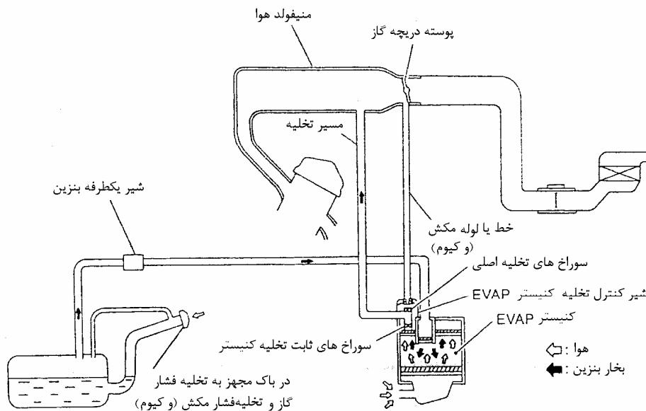
سیستم کنترل بخار بنزین برای کم کردن مقدار بخارات هیدرو کربن های منتشره در هوای آزاد بوسیله
