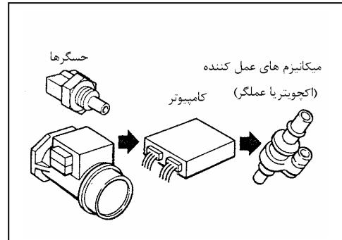
عیب یابی مسائلی که بطور غیر دائم (متناوب) اتفاق می‌افتد از مسائل دائمی بسیار مشکل تر است. بیشتر مسائل غیر دائم (متناوب) بعلت اتصالات ضعیف الکتریکی (مانند سوکت) یا سیم کشی نامناسب اتفاق می‌افتد. در این گونه موارد چک دقیق مدارات مشکوک ممکن است از تعویض بیهوده قطعات جلوگیری کند.
