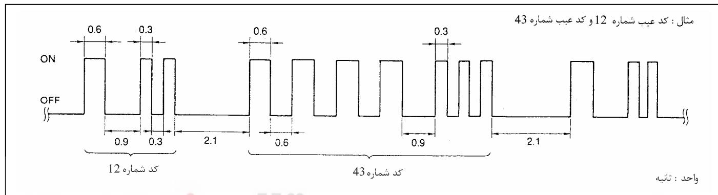
چشمک طولانی مدت (0.6 ثانیه) نشانگر دهگان و چشمک کوتاه مدت (0.3 ثانیه) نشانگر یکان شماره کد می‌باشد. بطول مثال، چراغ اعلام عیوب در حدود مدت 5 ثانیه 4 بار چشمک میزند (ثانیه  $0.6 \times 8$  بار خاموش روش) و سپس در حدود مدت 1 ثانیه سه بار چشمک میزند (ثانیه  $0.3 \times 3$  بار روشن شدن). این نمایش‌ها مشخص کننده کد عیوب شماره «43» می‌باشند که مربوط به عیوب حسگر موقعیت دریچه گاز می‌باشد.
